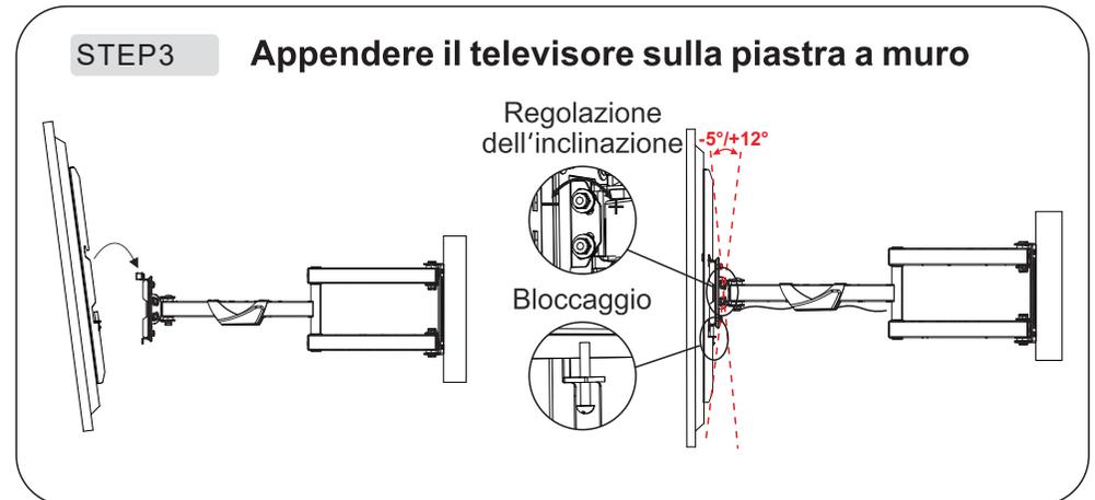
**ATTENZIONE:** Il muro su cui installare il supporto deve essere pieno, stabile e sicuro. Il produttore non si assume nessuna responsabilità in caso di ancoraggio non corretto o impiego diverso dal sostegno di TV.
